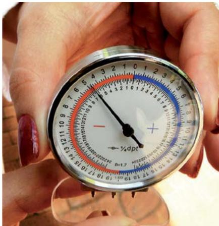
Figura1. Esferómetro actualizado para índice Alto
