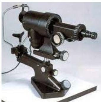
Fig 2. Queratómetro de Von Helmholtz
